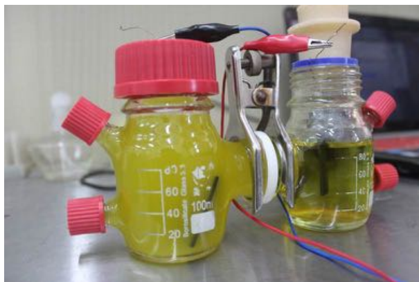
FIGURE I.1 — Photo d'une pile à bactérie conventionnelle. À gauche l'anode reliée par une membrane échangeuse de proton à la cathode à droite (Crédits : www.igem.org ).
