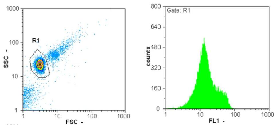
**FIGURE 4.8** – Mesure de référence : billes greffées avec des streptavidines mélangées avec une solution de bFITC. Le graphique à gauche, représente le signal en SSC en fonction de celui en FSC. Il permet de discriminer la population de singlets (R1). A droite est représenté l’histogramme fluorescent de cette population de singlets à 520 nm (gain 900).
