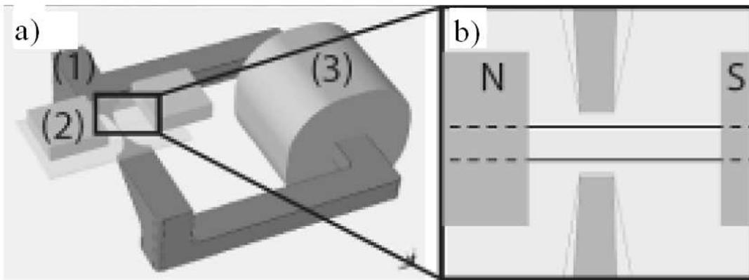
**FIGURE 4.2** – a) Vue schématique du système d'activation magnétique mis au point par l'EPFL (1) pointe magnétique (2) aimant permanent et (3) bobine. b) Zoom sur la configuration des pôles magnétiques près du canal microfluidique. Les aimants permanents ne sont pas placés symétriquement par rapport aux pointes magnétiques positionnées verticalement. Schémas fournis par l'EPFL.
