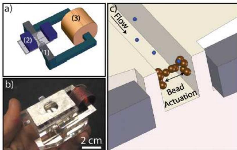
**FIGURE 4.5** – Vue schématique de la puce microfluidique et du système d'activation magnétique comprenant deux pointes magnétiques (1), deux petits aimants permanents (2) et une bobine (3). (b) Photographie de tout le système. Les aimants permanents sont placés sous une petite plaque de fer au dessus de la puce. (c) Vue schématique en 3D du déplacement des billes à travers le canal microfluidique entre les pointes magnétiques et la percolation d'échantillon [59].
