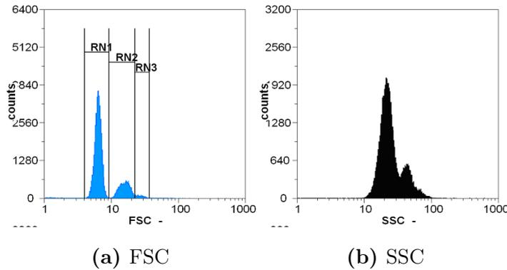
**FIGURE 3.27** – Signaux recueillis pour une solution de billes MyOne Streptavidin à 0,1 pM en présence de 50 pM de BSAb après application du champ magnétique.
