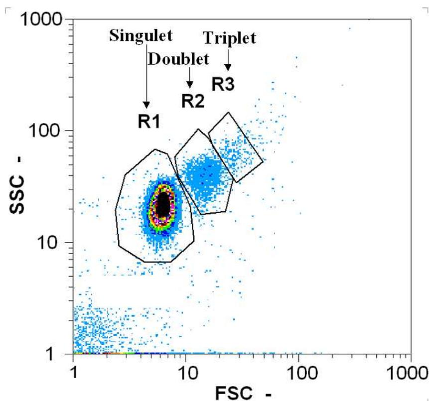
**FIGURE 3.26** – Cytogramme représentant SSC en fonction FSC pour une solution de billes de  $1\ \mu m$  greffées avec des streptavidines (Dynabeads MyOne Streptavidin)- solution témoin (sans BSA) après application du champ magnétique ( $B=50\ mT$  pendant 30s et  $B=1\ mT$  pendant 10 min). La concentration de la solution de billes injectée est à  $10^{-3}pM$ , le débit est de  $1\ \mu L/s$  soit  $\sim 1000$  objets/s et le temps d'injection est de 1 min.
