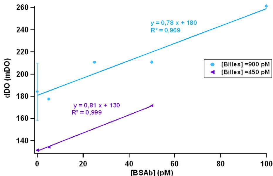
**FIGURE 3.15** – Evolution de la variation de densité optique en fonction de la concentration en BSAb pour deux concentrations de billes 450 et 900 pM, greffées par Ademtech avec des streptavidines après un champ de 30 mT pendant 10 min. Le milieu d'analyse est du tampon phosphate à 100 mM, pH= 6,7 avec 0,4 % de F-127. La mesure de densité optique est effectuée à 632 nm et  $R_{bille} = 75nm$ . Expérience réalisée par D. Lefebvre de Rieux.
