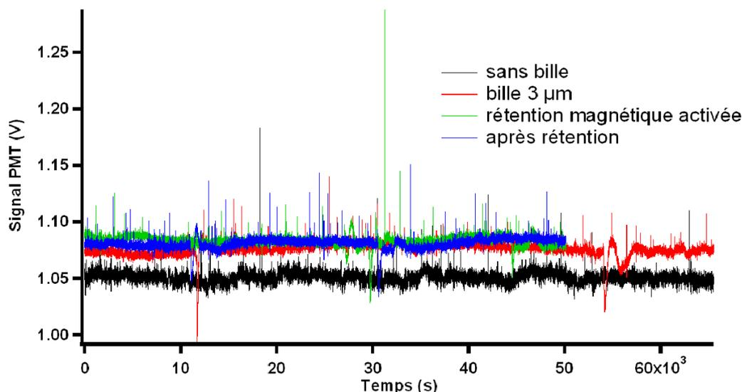
**FIGURE 5.26** – Données brutes du PMT correspondant à l'intensité diffusée par la solution passant dans le canal microfluidique devant le détecteur; en noir, sans bille - en rouge avec des billes magnétiques de  $3 \mu m$  de diamètre - en vert, avec des billes magnétiques en activant la rétention magnétique - en bleu, après arrêt de la rétention.
