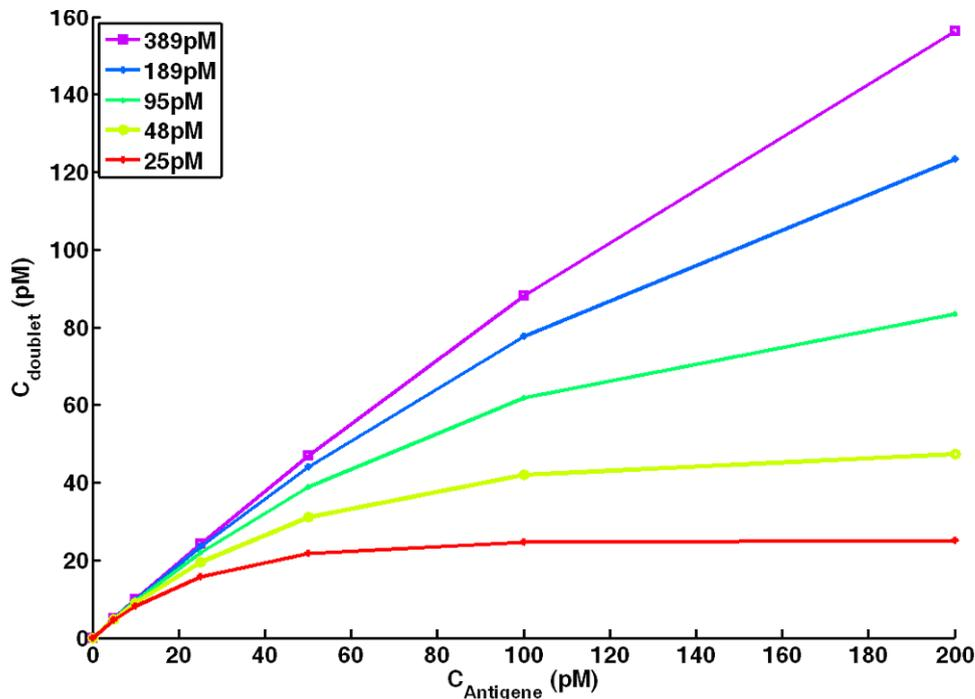
**FIGURE 3.10** – Simulation de la concentration de doublets en fonction de la quantité d'antigène pour cinq concentrations de billes 25, 48, 95, 189 et 378 pM à partir de la loi de poisson.
