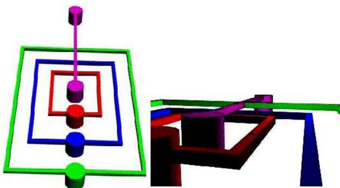
**FIGURE 5.5** – Plan (schéma) fluide de l'hydrofocalisation 3D de la puce. Les canaux bleu et rouge sont sous les canaux vert et violet. Le canal rouge contient l'échantillon, les autres du tampon.
