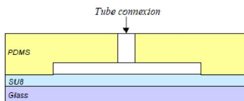
**FIGURE 5.6** – Vue schématique du sandwich verre/SU-8/PDMS pour la puce intégrée. Les tubes sont insérés directement dans le PDMS pour les connexions fluidiques.
