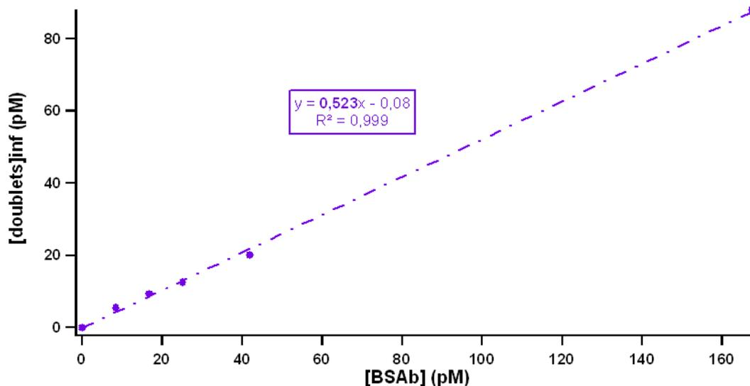
**FIGURE 2.19** – Evolution de la concentration de doublets à la saturation (extrapolation des données brutes) en fonction de la concentration en BSAb après application d'un champ magnétique de 30 mT pendant 10 min en milieu tamponné (tampon phosphate 250 mM, pH=8,5 avec 1 % de F-127). Les billes sont greffées avec une cinquantaine de streptavidines et la concentration de billes est de 70 pM. Expériences réalisées par M. de Geus
