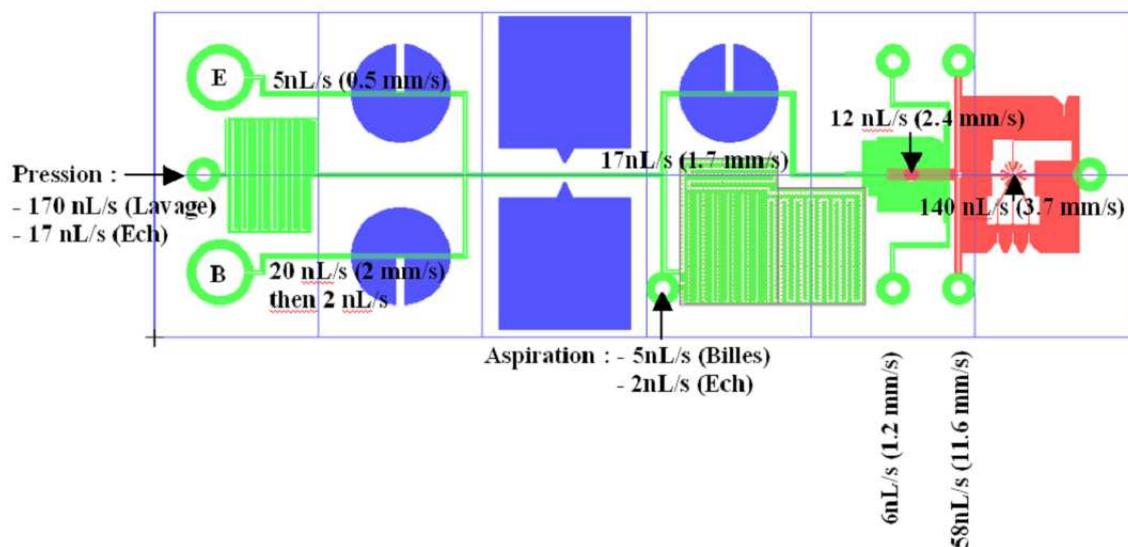
FIGURE 5.17 – Protocole fluide avec la valeur des débits pour les différentes parties.
