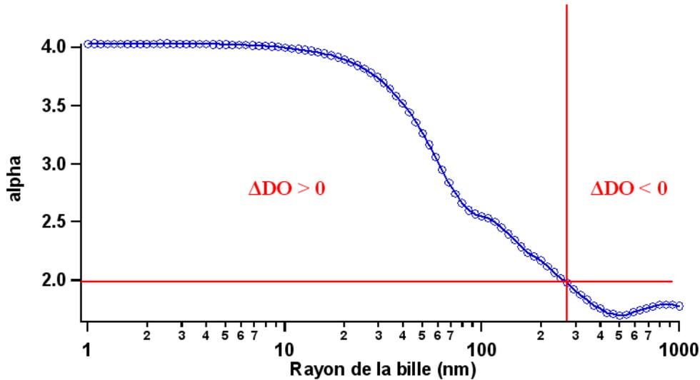
**FIGURE 3.13** – Evolution du paramètre alpha où  $\alpha = \frac{C_{DIFF}^2}{C_{DIFF}^1}$  en fonction du rayon de la bille, à 632 nm. Simulation numérique faite à partir du programme disponible sur internet [64].
