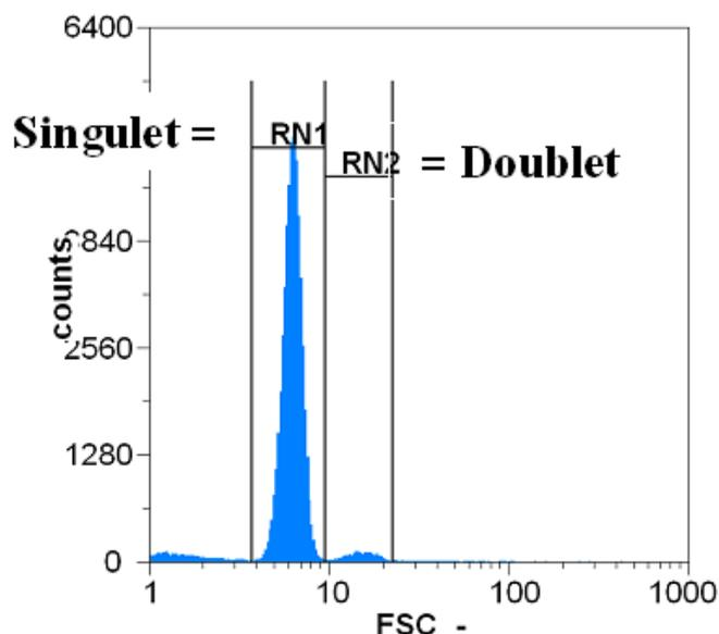
**FIGURE 3.24** – Signaux obtenus en FSC ( $1^{\circ}$ - $8^{\circ}$ ) pour une solution de billes de  $1 \mu m$  greffées avec des streptavidines (Dynabeads MyOne Streptavidin)- solution témoin (sans BSA) après application du champ magnétique. Histogramme représentant le nombre d'évènements en fonction de l'intensité. La concentration de la solution de billes injectée est à  $10^{-3} pM$ , le débit est de  $1 \mu L/s$  soit  $\sim 1000$  objets/s et le temps d'injection est de 1 min.
