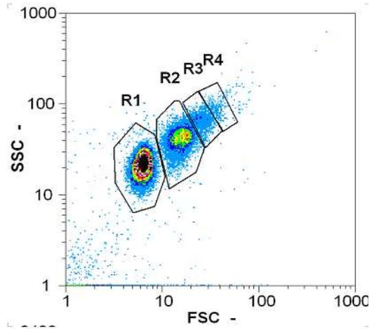
**FIGURE 3.28** – Cytogramme représentant SSC en fonction FSC pour une solution de billes MyOne Streptavidin à 0,1 pM en présence de 50 pM de BSAb après application du champ magnétique (B=50 mT pendant 30s et B=1 mT pendant 10 min).
