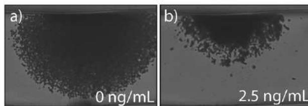
**FIGURE 4.6** – Photo du plug après arrêt du champ magnétique et passage de l'échantillon contenant 0 et 2,5  $\text{ng}\cdot\text{mL}^{-1}$  de BSA ( $M_{BSA} = 65000\text{g}\cdot\text{mol}^{-1}$ ) [59].
