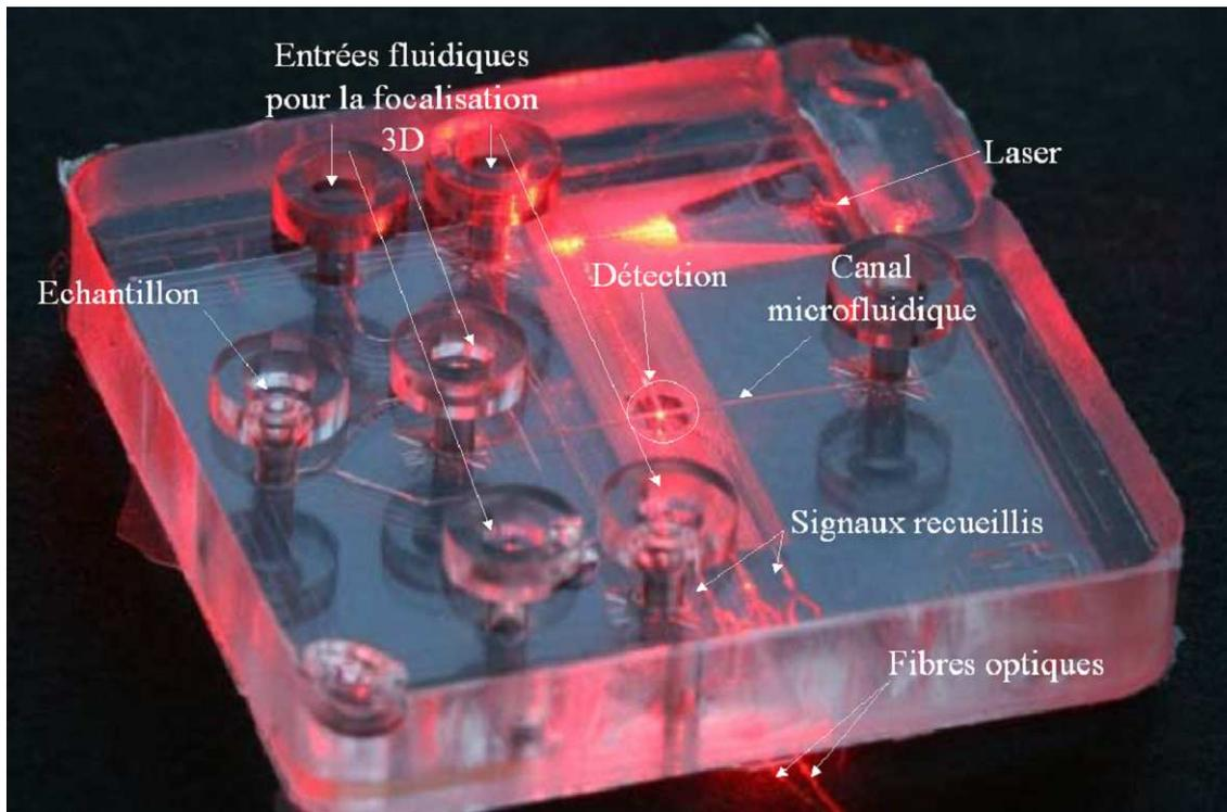
FIGURE 5.23 – Puce de détection optique développée par DTU.
