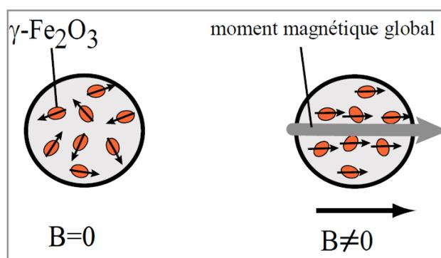
**FIGURE 2.11** – Particules superparamagnétiques répondant à un champ magnétique. Avec l'application du champ magnétique  $B$ , il apparaît un moment magnétique induit au niveau de la particule (flèche grise).
