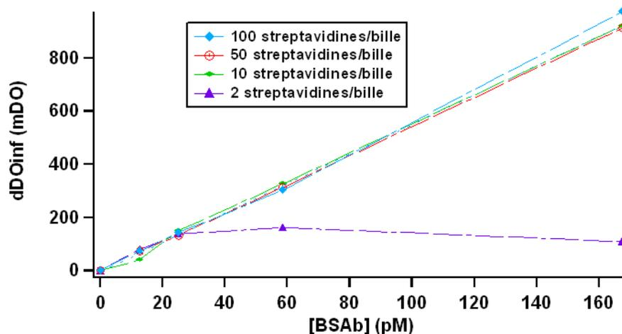
**FIGURE 3.7** – Evolution de la variation de densité optique à l'infinie (valeur extrapolée à partir de la DO expérimentale) en fonction de la concentration en BSAb pour quatre taux de greffage différents 2, 10, 50 et 100 streptavidines à la concentration de 70 pM . greffées par Ademtech avec des streptavidines après un champ de 30 mT pendant 10 min. Le milieu d'analyse est du tampon phosphate à 100 mM, pH= 6,7 avec 0,4 % de F-127. Expérience réalisée par M. de Geus.
