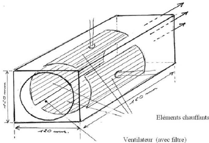
FIGURE 5.14 – Principe de la régulation thermique
