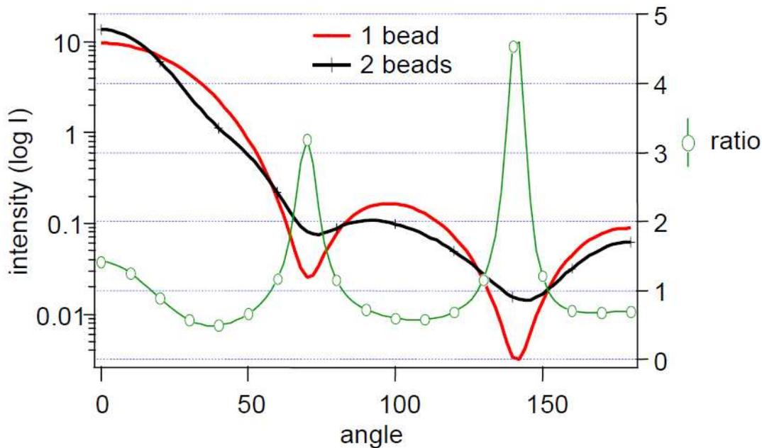
**FIGURE 3.16** – Représentation du logarithme de l'intensité diffusée par des billes de 500 nm de diamètre en fonction de l'angle d'observation à 633 nm. En rouge, pour une bille et en noir pour deux billes (modèle pour les doublets).
