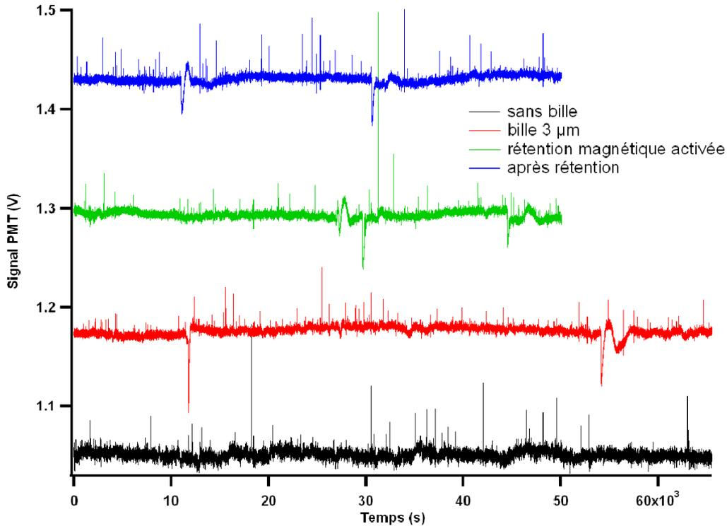
**FIGURE 5.27** – Les signaux précédents sont décalés afin de mieux les comparer ; en noir, sans bille - en rouge avec des billes magnétiques de  $3 \mu m$  de diamètre - en vert, avec des billes magnétiques en activant la rétention magnétique - en bleu, après arrêt de la rétention.
