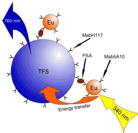
**FIGURE 2.22** – Représentation du transfert d'énergie après réaction immunologique. La nanoparticule donneuse en europium (diamètre de 107 nm) est greffée avec des anticorps 5A10-anti-PSA et la nanoparticule acceptrice en TFS (diamètre de  $2\mu\text{m}$ ) est greffée avec des anticorps H117-anti-PSA. La taille des particules n'est pas proportionnelle [32].
