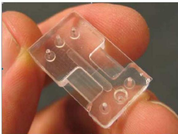
**FIGURE 5.3** – Puce en PDMS collée sur du verre avec une partie rétrécie pour insérer les pointes magnétiques. Le microcanal mesure  $100\ \mu\text{m}$  sur  $100\ \mu\text{m}$  avec à ces extrémités des trous pour les connections fluidiques[59].
