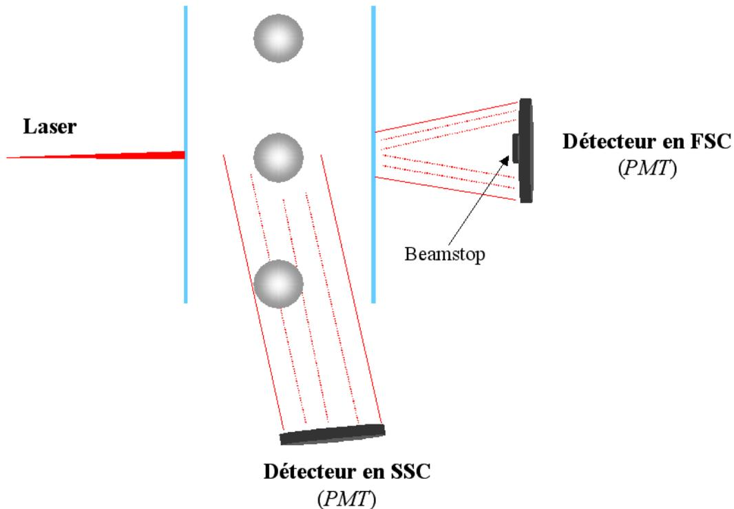
FIGURE 3.23 – Schématisation de la détection optique.
