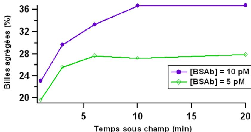
**FIGURE 3.33** – Evolution du pourcentage de billes agrégées en fonction du temps d'application du champ magnétique de 1mT. La concentration de billes est de 0,1 pM. Un champ magnétique fort de 50 mT est appliqué pendant 30s avant l'application du champ faible. Le temps d'application du champ magnétique faible est de 10 min. Expérience réalisée par D. Lefebvre de Rieux.
