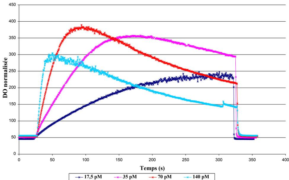
**FIGURE 3.3** – Evolution de la densité optique normalisée par la fraction massique de billes pour différentes concentrations de billes non greffées (billes COOH) 17,5 ; 35 ; 70 et 140 pM sous un champ magnétique de 30 mT pendant 5 min. Expérience réalisée par H. Gouthière. La mesure de densité optique est effectuée à 632 nm.
