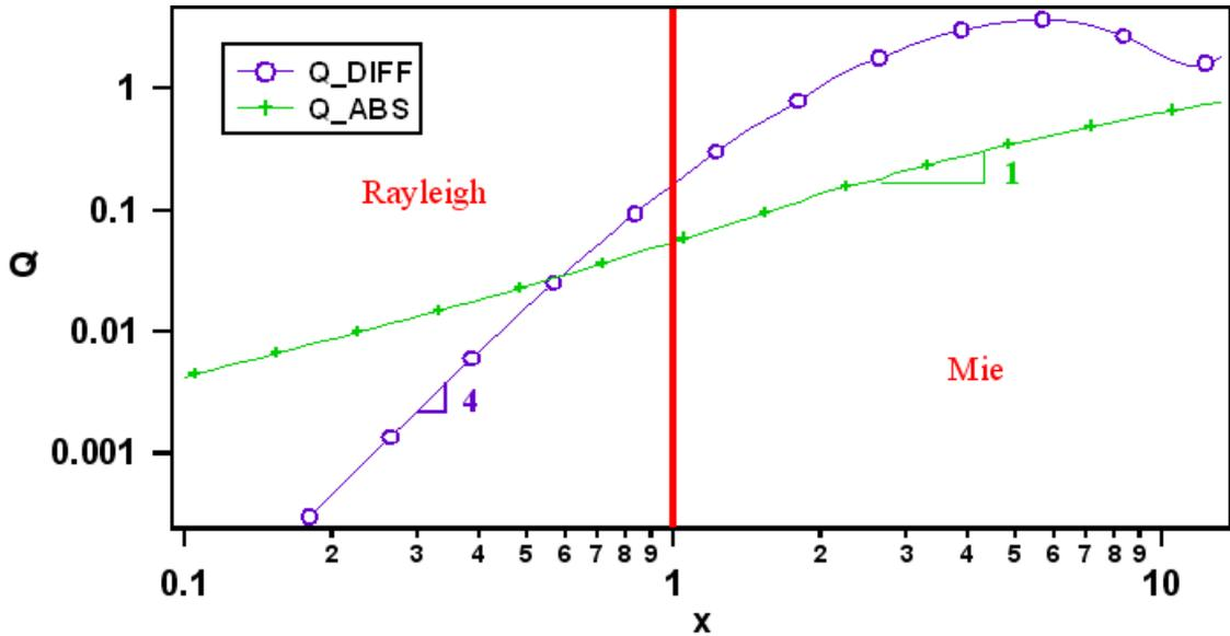
**FIGURE 3.12** – Evolution de l'efficacité  $Q$  d'absorption (croix) et de diffusion (cercle) d'une bille en fonction de  $x$ , avec  $Q = \frac{C}{\pi R_{bille}^2}$  en échelle log-log. Simulation numérique faite à partir du programme disponible sur internet [64].
