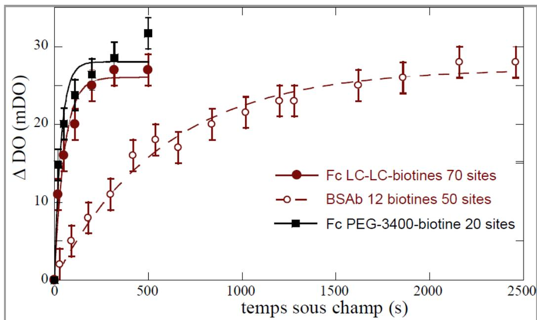
**FIGURE 2.18** – Cinétique de formation de doublets sous un champ de 30 mT, pour différentes configurations symétriques. Avec liaison à la surface par un PEG-3400 (15 nm) ■, par un "LC-LC" (3 nm) ● et par contact direct ○.
