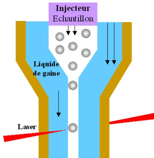
FIGURE 3.22 – Principe de la focalisation hydrodynamique dans un cytomètre à flux.
