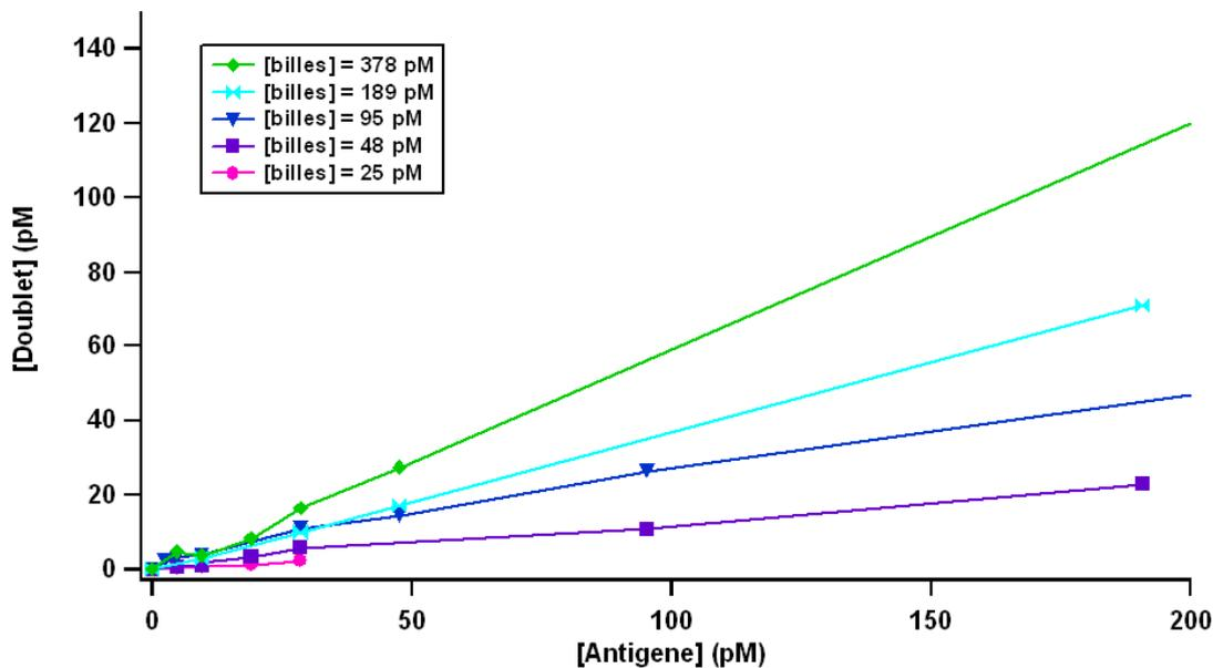
**FIGURE 3.8** – Evolution de la concentration de doublets en milieu tamponné (formulation non renseignée) en fonction de la concentration en antigènes pour cinq concentrations de billes 25, 48, 95, 189 et 389 pM après un champ de 30 mT pendant 10 min. Expérience réalisée par D. Lefebvre de Rieux.
