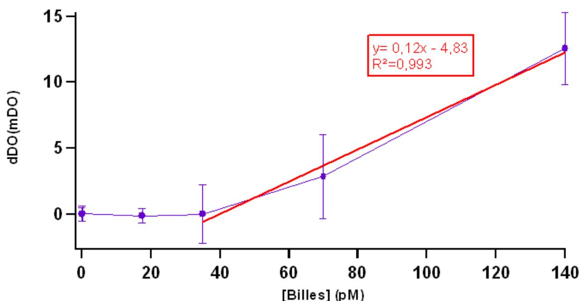
**FIGURE 3.5** – Evolution de la variation de densité optique normalisée par la dérive en fonction de la concentration de billes COOH après un champ de 30 mT pendant 10 min. Le milieu d'analyse est du tampon phosphate à 100 mM, pH= 6,7 avec 0,4 % de F-127. Toutes les mesures sont réalisées trois fois.
