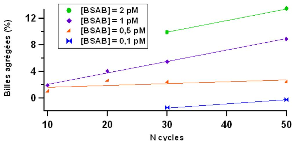
**FIGURE 3.35** – Evolution du pourcentage de billes agrégées en fonction du nombre de cycles de champ magnétique pour quatre concentrations en BSAb (0,1 ; 0,5 ; 1 et 2pM). Expérience réalisée par D. Lefebvre de Rieux.
