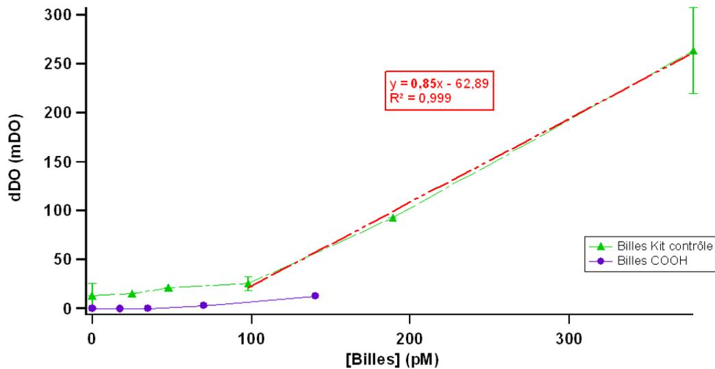
**FIGURE 3.6** – Evolution de la variation de densité optique en milieu tamponné (formulation non renseignée) en fonction de la concentration en billes après un champ de 30 mT pendant 10 min. Les billes sont issues de kit contrôle positif développé par Bertin Technologies. Expérience réalisée par D. Lefebvre de Rieux.
