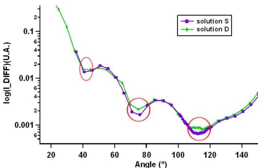
**FIGURE 3.21** – Superposition du logarithme de l'intensité diffusée à 633 nm par les solutions S (en violet) et D (en vert) en fonction de l'angle d'observation.
