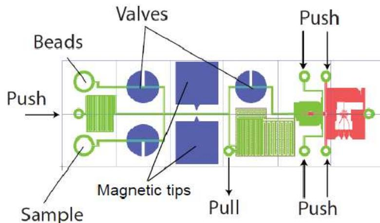
**FIGURE 5.11** – Vue schématique de la puce intégrée. Vert : couche de PDMS, rouge : couche de SU8, bleu : valves et pôles magnétiques.
