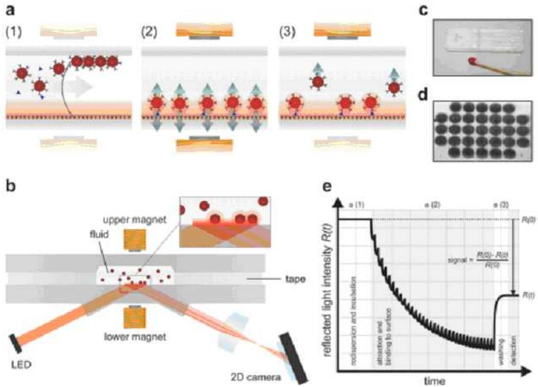
**FIGURE 2.24** – Principe du test développé par Philips pour détecter une concentration inférieure à la picomole du marqueur cardiaque, la troponine I, en quelques minutes [45].
