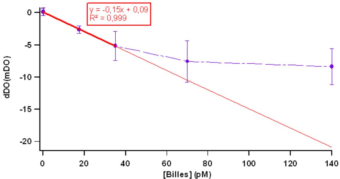
**FIGURE 3.4** – Evolution de la variation de densité optique en fonction de la concentration de billes COOH après un champ de 30 mT pendant 10 min. Le milieu d'analyse est du tampon phosphate à 100 mM, pH= 6,7 avec 0,4 % de F-127. Toutes les mesures sont réalisées trois fois.
