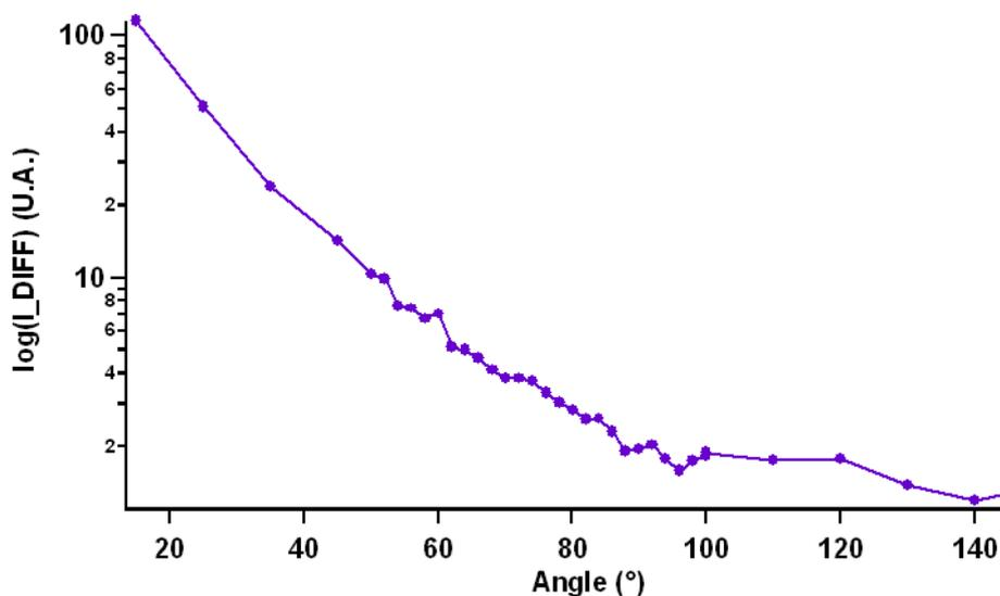
**FIGURE 3.18** – Représentation du logarithme de l'intensité diffusée à 633 nm par une suspension de billes magnétique de 500 nm de diamètre à  $10^{-4}\%$  en masse en fonction de l'angle d'observation.
