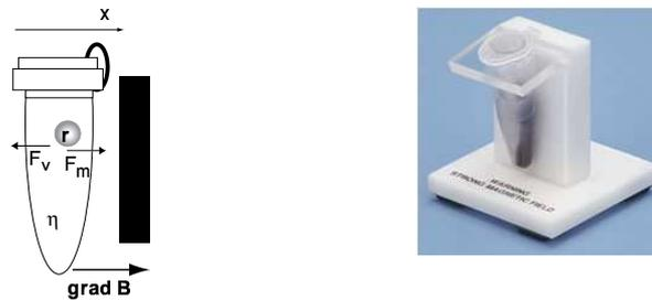
FIG. 1.5 – Principe de la séparation magnétique : la particule est soumise à une force magnétique qui attire la particule vers l'aimant et une force de friction qui s'y oppose. Sur le cliché, le surnageant est devenu limpide signe que toutes les particules sont regroupées sur la paroi de l'épendorf en contact avec l'aimant (Cliché extrait de [www.qiagen.com](http://www.qiagen.com))
