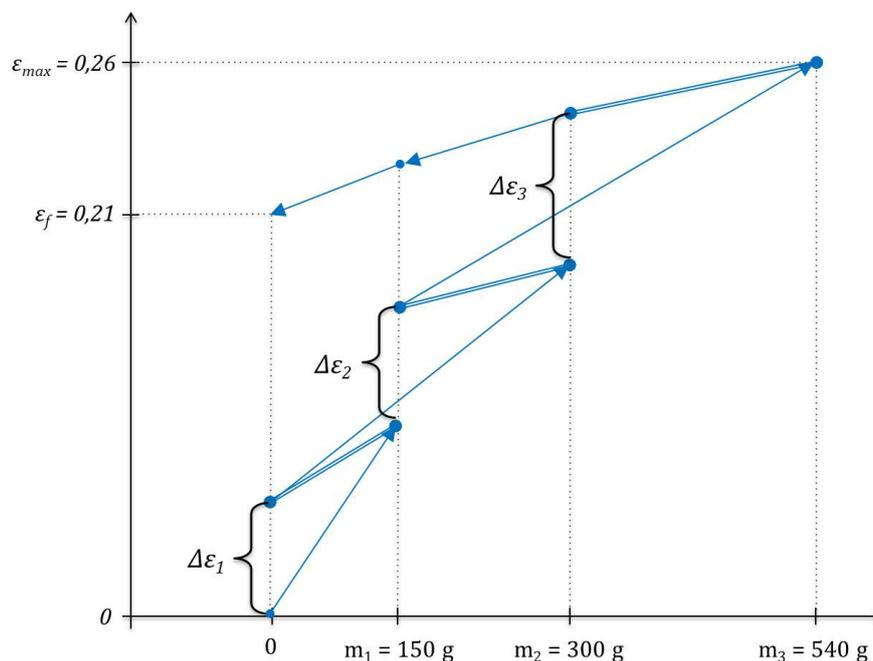
**Figure 8.6** – Schéma de la courbe d'hystérèse du système. *Inséré* : Courbe expérimentale correspondante.
