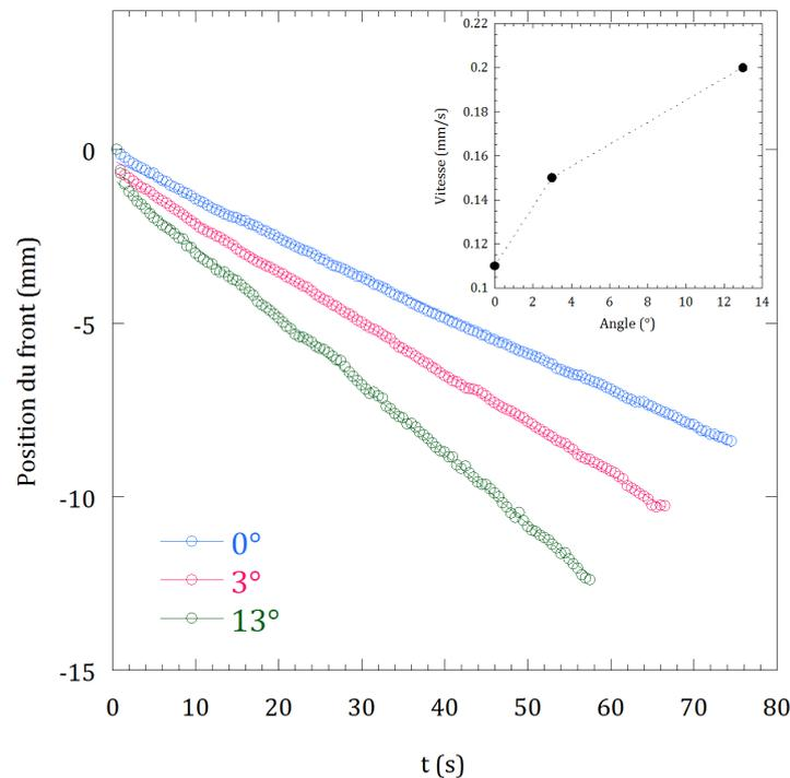
**Figure 9.11** – Position du front arrière en fonction du temps pour trois différents angles  $\theta$ .
