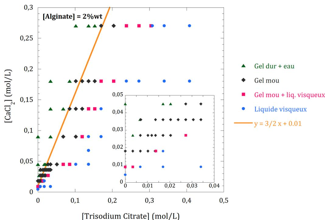
**Figure 3.5** – Diagramme de phase d'une mélange ternaire alginate/calcium/citrate. La concentration de l'alginate est fixée à 2% en masse et on fait varier les concentrations en chlorure de calcium et citrate de sodium.
