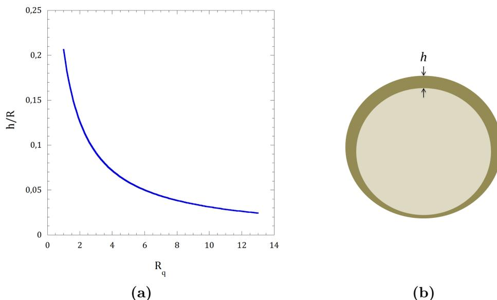
**Figure 2.6** – (a) Épaisseur moyenne relative théorique de la membrane d’alginate d’une capsule de rayon  $R$  en fonction du ratio des débits  $R_q$ . (b) Schéma d’une capsule de forme sphéroïdale composée d’une membrane d’épaisseur non homogène  $h$ .
