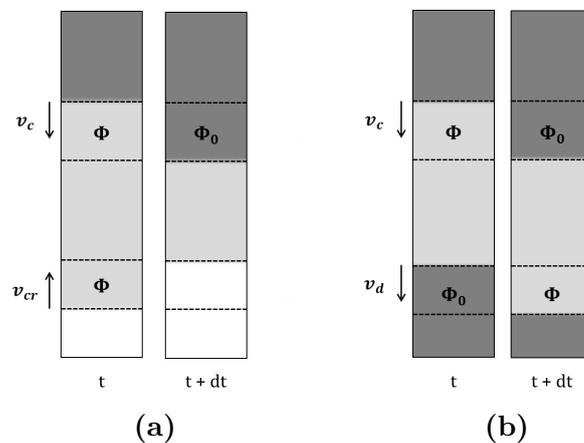
**Figure 9.23** – (a) Schéma du bilan de matière entre la vitesse de compaction  $v_c$  et la vitesse de crémage fluide  $v_{cr}$ . (b) Schéma du bilan de matière entre la vitesse de compaction  $v_c$  et la vitesse de décompaction  $v_d$ .
