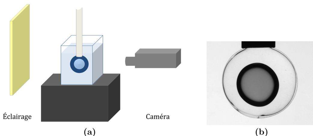
**Figure 5.8** – (a) Schéma de l'expérience de fuite de l'eau à travers la membrane d'une DPi. (b) Image d'une DPi contenant de l'eau et maintenue immergée dans un bain de  $\text{CaCl}_2$  par une aiguille non biseautée. On distingue le cœur aqueux en noir, entouré par la couche d'huile siliconée, ainsi que la membrane fine d'alginate perméable. On remarque que la DPi n'est pas parfaitement sphérique et le cœur n'est pas parfaitement centré.
