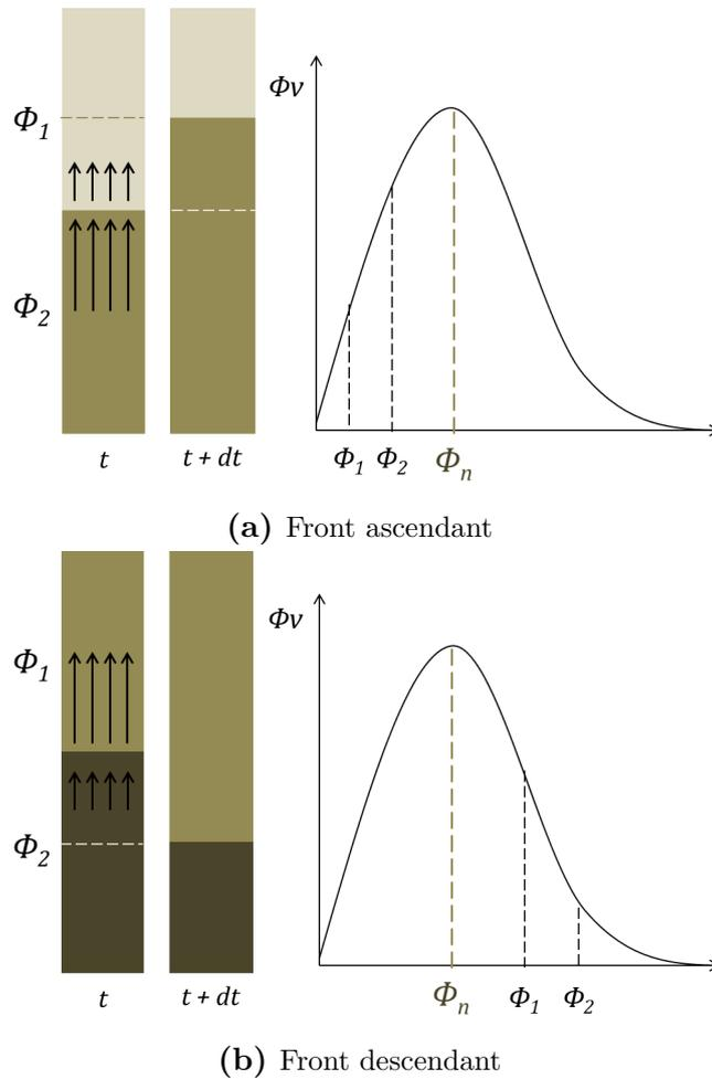
**Figure 9.17** – Représentation schématique d'une discontinuité de concentration dans un tube contenant des capsules qui crèment. (a)  $\Phi_2 > \Phi_1$  et  $\Phi_2 v_2 > \Phi_1 v_1$ . (b) Cas où  $\Phi_2 > \Phi_1$  et  $\Phi_2 v_2 < \Phi_1 v_1$ . Les flèches symbolisent la vitesse du flux.
