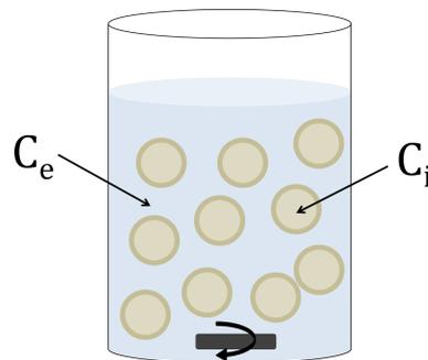
**Figure 4.1** – Expérience de fuite sur 10 capsules de glucose ou de dextran encapsulés à la concentration  $C_i^0$ . L'évolution de la concentration dans le bain  $C_e$  est mesurée au cours du temps à  $T=23^\circ\text{C}$ .
