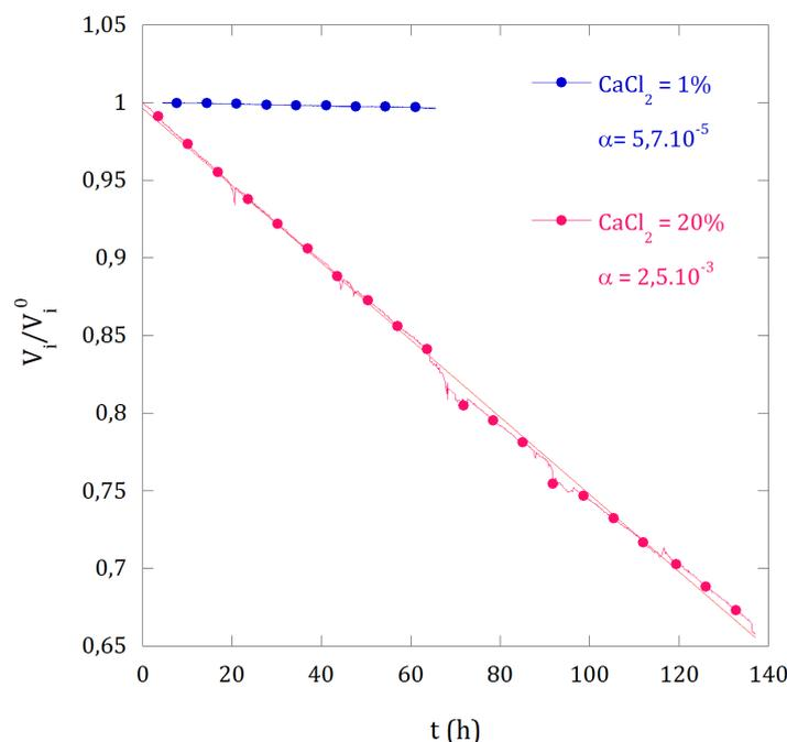
**Figure 5.9** – Diminution linéaire du volume du cœur de la DPi au cours du temps pour deux concentrations en sel dans le bain extérieur. Les points expérimentaux ont été ajustés par une loi de type  $y = 1 - \alpha x$ .
