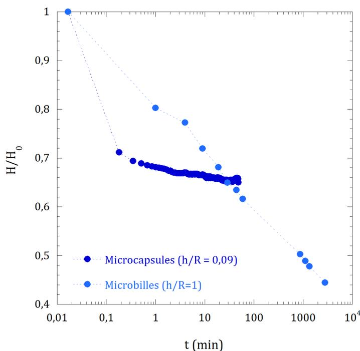
**Figure 8.2** – Variation de la hauteur  $H$  de microcapsules et de microbilles normalisée par la hauteur initiale  $H_0$  en fonction du temps après l'application d'un piston de masse égale 630 g (respectivement 304 g).
