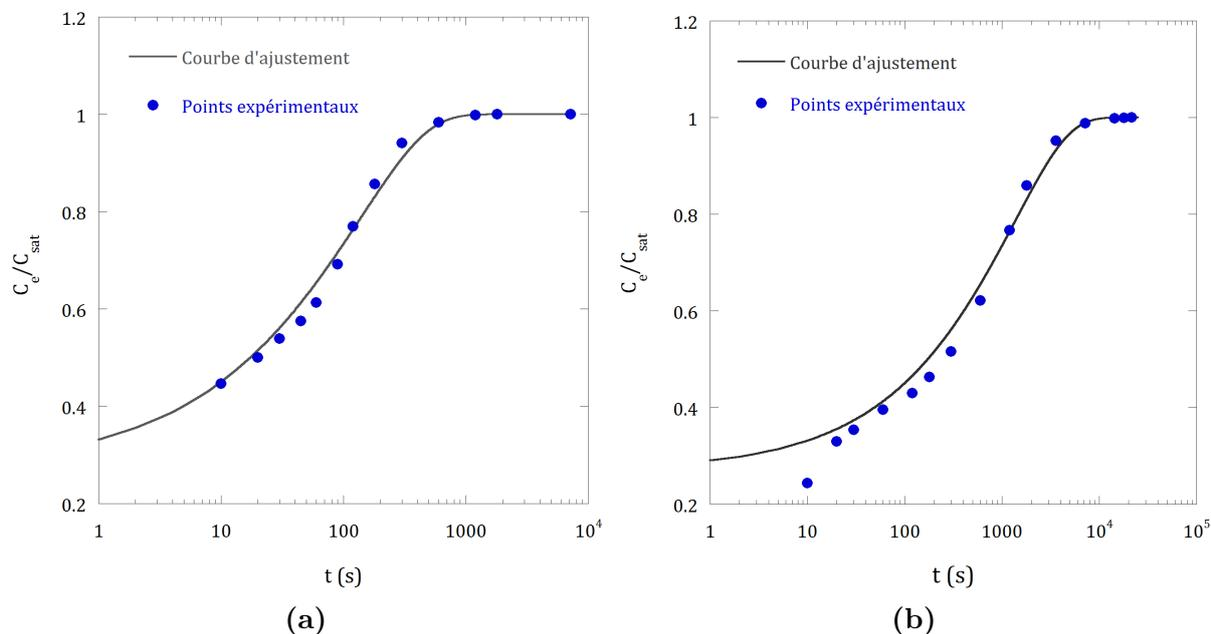
**Figure 4.4** – Cinétique de diffusion du glucose (a) et du Dextran 20 (b) encapsulés à la concentration initiale  $C_i^0 = 0,1$  g/mL.  $C_e/C_{sat}$  est la concentration mesurée dans le bain extérieur, normalisée par la concentration maximale à saturation.
