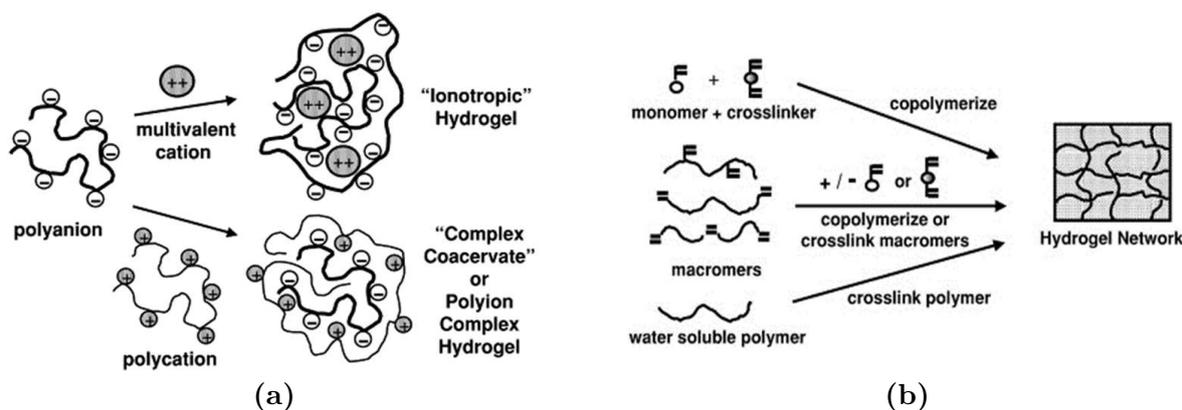
**Figure 1.2 – (a)** Schéma de formation de deux types d'hydrogels physiques ioniques : un d'hydrogel "ionotrope" (ex : alginate de calcium) et un hydrogel polyionique (ex : complexe d'alginate avec la polylysine). **(b)** Schéma de formation d'un hydrogel chimique par différents types de polymérisation ou réticulation de polymères hydrosolubles. Adapté de [Hoffman, 2002].
