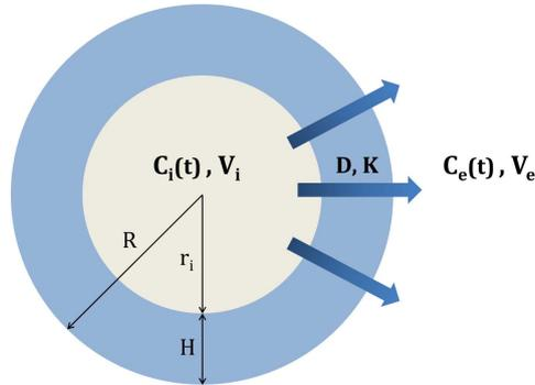
**Figure 5.3** – Schéma d'une capsule millimétrique à cœur aqueux contenant un soluté à la concentration  $C_i$  et une membrane huileuse d'épaisseur  $H$ .
