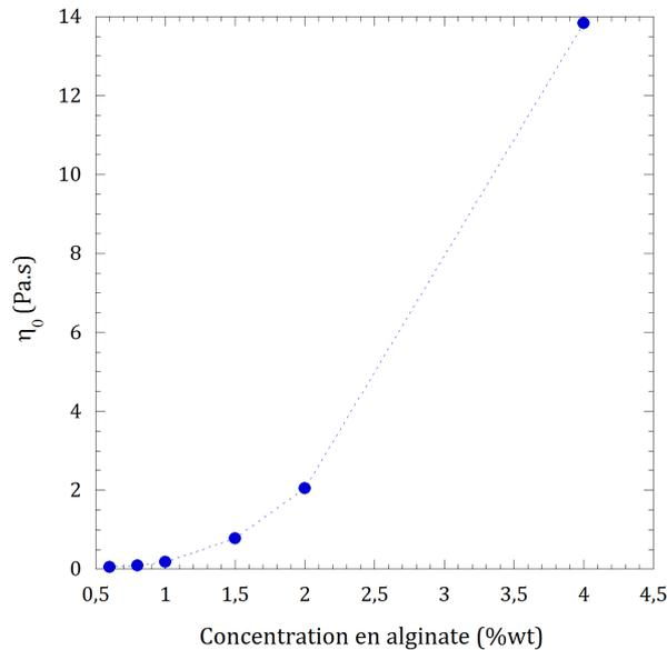
**Figure 2.7** – Mesures de la viscosité à cisaillement nul pour différentes concentrations massiques d'alginate LF200s (*expérience réalisée par H. Doméjean*).
