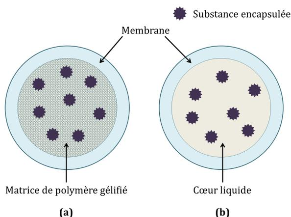
**Figure 2.1** – Deux différents types de structures : **(a)** Microbille : les composés sont incorporés dans un cœur de matrice polymérique réticulée éventuellement enrobé d'une membrane. Il n'y a pas de distinction claire entre la membrane et le cœur qui sont tous les deux solides. **(b)** Microcapsule : les composés sont dispersés dans un cœur liquide enveloppé par une membrane polymérique réticulée.
