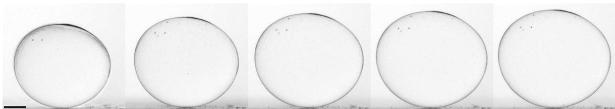
**Figure 7.2** – Échantillon d'images d'une capsule soumise à l'expérience de gonflement osmotique.  $\Delta t = 15$  min. Échelle = 1 mm.
