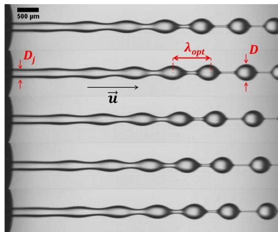
**Figure 2.12** – Fragmentation d'un jet composé d'alginate et d'une solution de Dextran. Fréquence d'excitation = 1500 Hz,  $\Delta t=0,1$ ms. Pour des raisons de commodités, les clichés sont présentés horizontalement, mais il faut bien imaginer un jet vertical dans l'expérience. (Crédits Hugo Doméjean).
