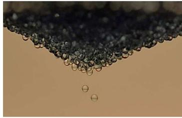
**Figure 9.3** – Photo de capsules formant un tas dont l’angle de talus est environ égal à  $35^\circ$ . Les capsules composées d’un cœur huileux remontent sous l’effet de la poussée d’Archimède.
