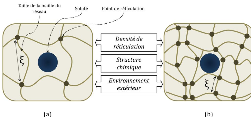
**Figure 1.3** – Schéma d'un soluté dans un hydrogel : **(a)** La taille du soluté est petit par rapport à la maille du réseau, il peut diffuser librement. **(b)** Le soluté a une taille de l'ordre de la taille de maille du réseau, il est piégé par les polymères. La porosité du gel peut être "réglée" en jouant sur différents paramètres tels que la densité de réticulation, la structure chimique du polymère et l'environnement extérieur (pH, température, force ionique etc...).
