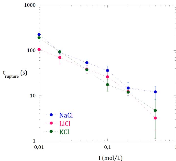
**Figure 3.10** – Variation du temps de rupture d'une capsule dans un volume infini de sel en fonction de la force ionique de la solution. L'influence de la taille du cation a été étudiée en réalisant l'expérience dans une solution de chlorure de sodium, chlorure de lithium ou de chlorure de potassium.
