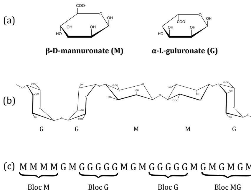
**Figure 3.1** – Structure et composition de l'alginate : (a) monomères d'acides uroniques, (b) conformation des chaînes et (c) distribution des blocs.
