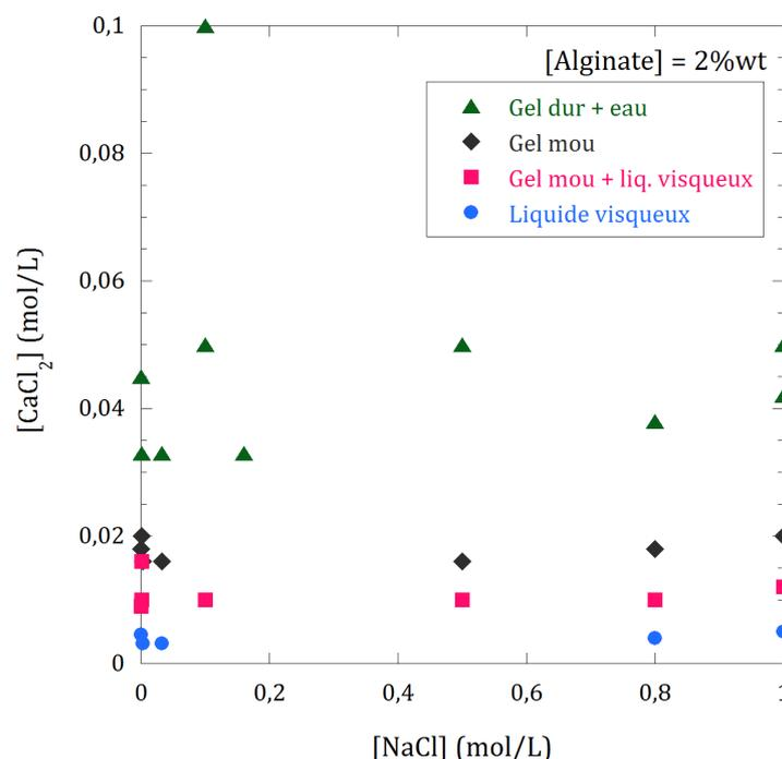
**Figure 3.7** – Diagramme de phase d'une mélange ternaire alginate/calcium/sodium. La concentration de l'alginate est fixée à 2% en masse et on fait varier les concentrations en chlorure de calcium et chlorure de sodium.
