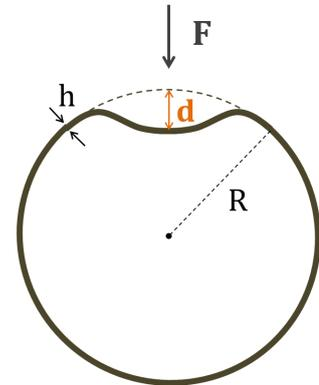
**Exemples :** Rachik et al. [2006] ont réalisé des tests de compression de microcapsules artificielles à membrane d'hydrogel. Ils ont comparé leurs expériences à des simulations numériques afin de valider des modèles théoriques de compression d'une membrane fine. Ils ont ainsi vérifié que le module d'Young  $E$  de la membrane augmente de manière non linéaire avec l'épaisseur de la membrane.
