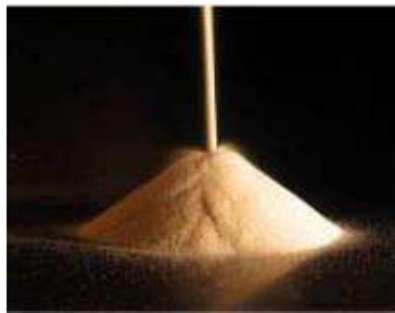
**Figure 9.2** – Illustration d'écoulement de sable formant un tas dont l'angle de talus est égal à  $35^\circ$  environ [Duran, 1997].
