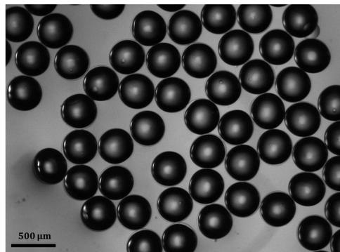
**Figure 2.13** – Image au microscope ( $\times 2$ ) de microcapsules constituées d'un cœur d'huile et d'une membrane d'alginate. Le diamètre des capsules est d'environ  $412 \pm 4,1 \mu\text{m}$ . Les capsules ont été fabriquées avec un injecteur de 100  $\mu\text{m}$  à une fréquence d'excitation de 600 Hz. Le débit du fluide interne était de 75 mL/h et celui du fluide externe de 25 mL/h.
