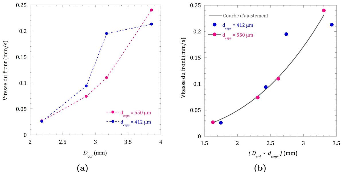
**Figure 9.13** – (a) Vitesse de montée du front de capsules en fonction du diamètre du col pour deux tailles de capsules. (b) Vitesse de montée du front de capsules en fonction de la différence entre le diamètre du col et de diamètre des capsules ( $D_{col} - d_{capsules}$ ) pour deux tailles de capsules.
