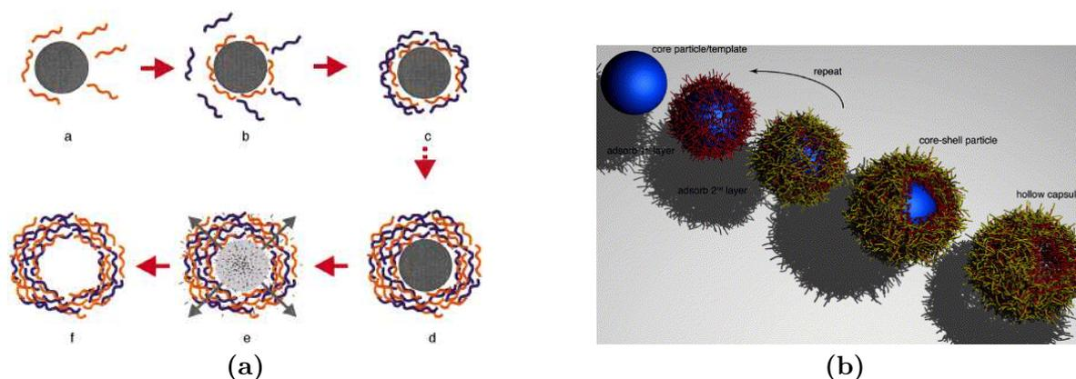
**Figure 2.2** – Illustrations schématiques de la formation de capsule par polymérisation multicouches. Des couches successives sont déposées à la surface d'un colloïde exposé alternativement à des polymères de charges opposées. La matrice du colloïde est ensuite dissoute pour former une capsule à cœur liquide. (a) Adapté de [Donath et al., 1998], (b) Adapté de [Johnston et al., 2006].
