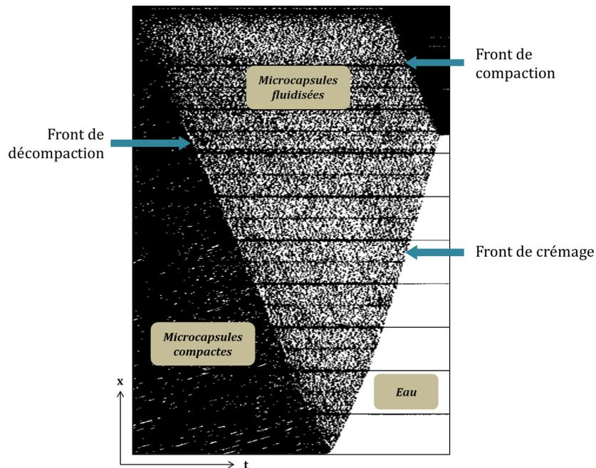
**Figure 9.21** – Diagramme spatio-temporel expérimental du crémage de microcapsules dans une colonne d'eau. Expérience réalisée avec des capsules de diamètre  $412 \mu\text{m}$  et un diamètre de tube  $D$  égal à 3 mm.
