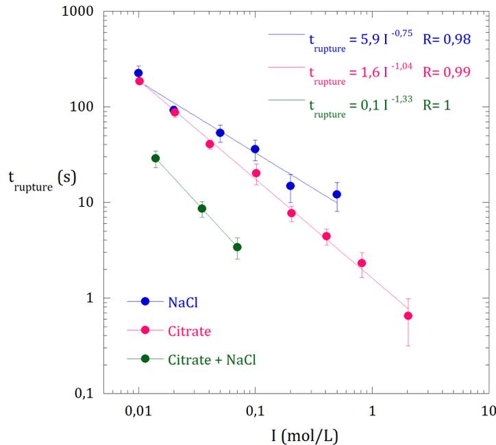
**Figure 3.9** – Variation du temps de rupture d'une capsule dans un volume infini de sel en fonction de la force ionique de la solution. L'expérience a été réalisée dans une solution de citrate de sodium, de chlorure de sodium et dans une mélange des deux sels. Les points expérimentaux ont été ajustés par une loi de puissance du type  $y = \alpha x^\beta$ .
