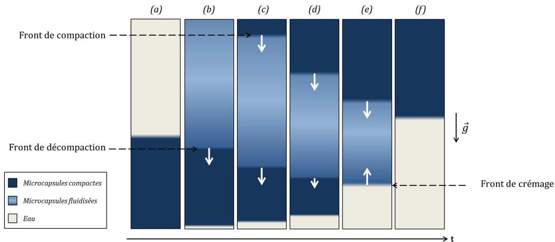
**Figure 9.22** – Représentation schématique du crépage de microcapsules d'huile dans une colonne d'eau. Les flèches blanches traduisent le mouvement de la position des différents fronts.
