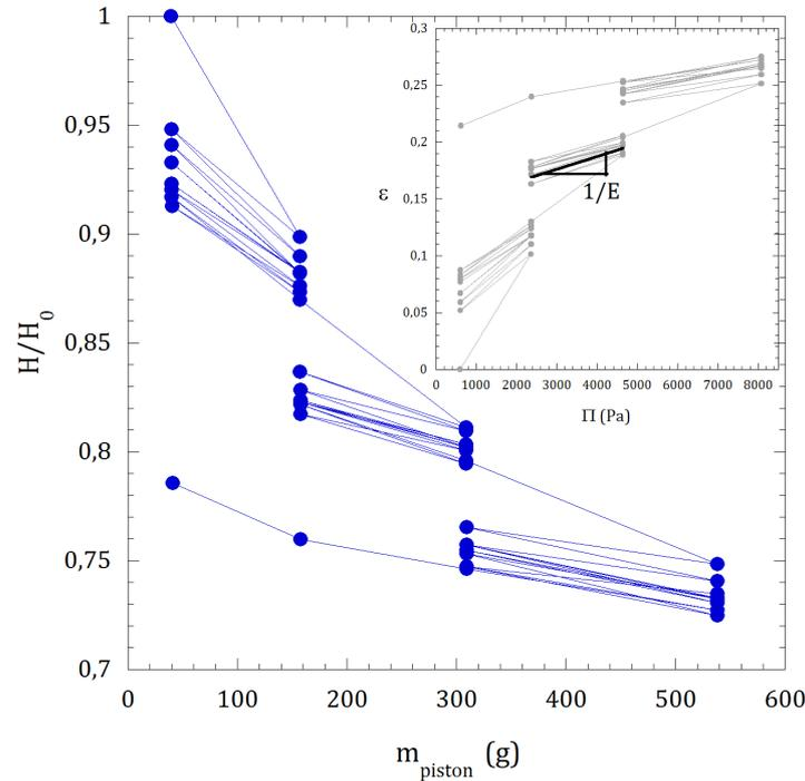
**Figure 8.5** – Variation de hauteur de capsules  $H$  normalisée par la hauteur initiale  $H_0$  en fonction de la masse du piston  $m_{piston}$ . *Inséré* : Variation de l’allongement  $\epsilon$  en fonction de la pression  $\Pi$  appliquée sur les capsules.
